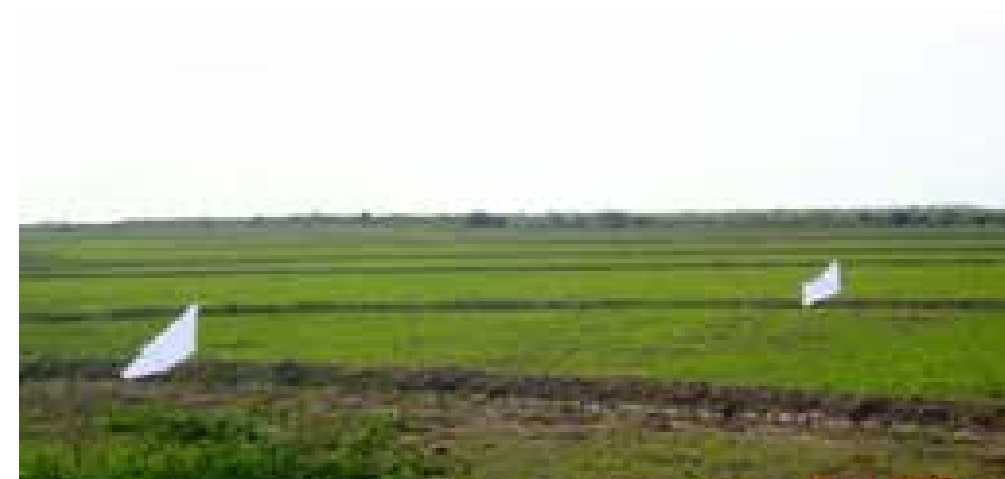
Figura 2. Área delimitada para el vuelo, las banderas indican el centro de la pasada del avión
